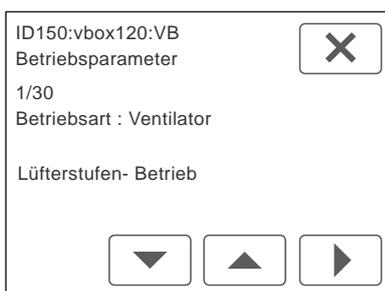
Anzahl und Name der Parameter für die Lüftung werden angezeigt. Die Anzahl ist variabel.
