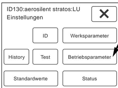
Wählen Sie die Schaltfläche „Betriebsparameter“, um Einstellungen für die Lüftung vorzunehmen.
